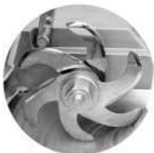
Cabezal con 6 cuchillas
